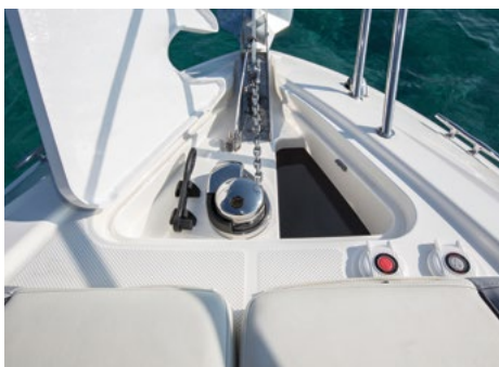
Pozo de Ancla con Molinete
